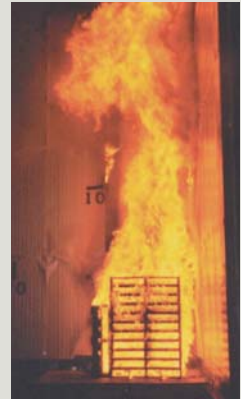
Brandwerendheidstest van een gevel
