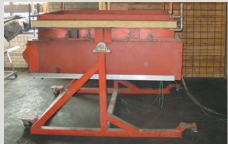
Pre-flashover test - oven met dakconstructie (BDA Keuringsinstituut B.V.)
