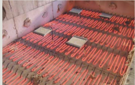
Pre-flashover test - binnenzijde van de oven (BDA Keuringsinstituut B.V.)
